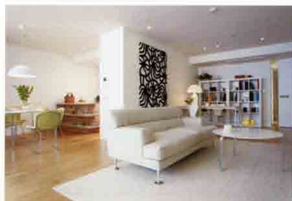
西棟住戸のモデルルーム。中央の壁は構造ではない間仕切り壁。住戸内を回遊できる平面計画となっている。*
