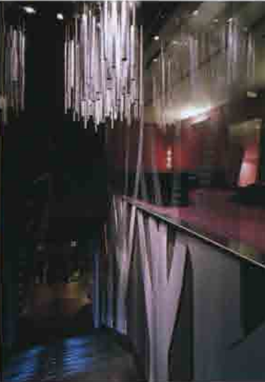
97頁：レンズスポットにより四角く切り取られた光が本棚風の壁面を照らしている。 左頁：入り口付近から地下1階の店内を見通す。女性の手鏡をイメージさせる「コンパクト」と呼ばれる天井部は特注のメラミン化粧板が貼られている。間接照明の入った平型仕器は柔らかい光を漏れている。上：店内奥から見返す。突き当たりに見える入り口すぐ脇の壁面は色温度の高い光を当て、壁面自体が青く光っているように見せている。 左：1階のVIPルームにつながる階段室。大きなローレット（ギザギザ状）の加工を施したアルミパイプでオブジェを製作し、天井からジャンテリアのように吊した。このオブジェに天井面からスポットライトで光を当て込むことで、オブジェ自体が発光しているように感じられる。階段の段鼻に滑り止めとして設置したステンレスバーには、超集光レンズを付けたLEDで1段階ずつ光を当てた。バーには光の方向とは直角にヘアラインを入れ、細かい反射を得ている。
