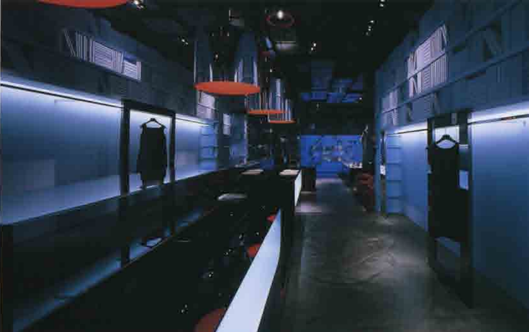
97頁：レンズスポットにより四角く切り取られた光が本棚風の壁面を照らしている。 左頁：入り口付近から地下1階の店内を見通す。女性の手鏡をイメージさせる「コンパクト」と呼ばれる天井部は特注のメラミン化粧板が貼られている。間接照明の入った平型仕器は柔らかい光を漏れている。上：店内奥から見返す。突き当たりに見える入り口すぐ脇の壁面は色温度の高い光を当て、壁面自体が青く光っているように見せている。 左：1階のVIPルームにつながる階段室。大きなローレット（ギザギザ状）の加工を施したアルミパイプでオブジェを製作し、天井からジャンテリアのように吊した。このオブジェに天井面からスポットライトで光を当て込むことで、オブジェ自体が発光しているように感じられる。階段の段鼻に滑り止めとして設置したステンレスバーには、超集光レンズを付けたLEDで1段階ずつ光を当てた。バーには光の方向とは直角にヘアラインを入れ、細かい反射を得ている。
